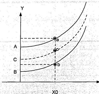
Figura 30. Interpolación logarítmica para el cálculo de coordenadas ubicadas entre las curvas de cada gráfica.
