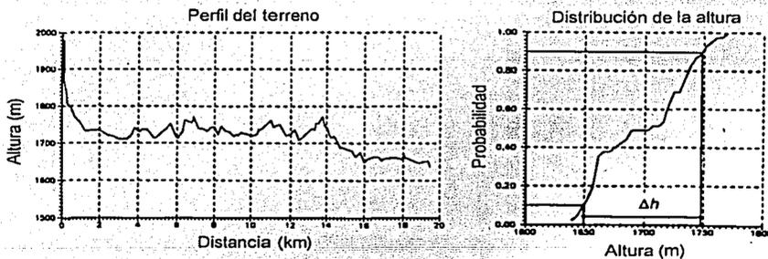
Figura 18. Perfil del terreno y su distribución de probabilidad
