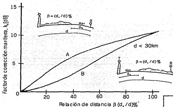
Figura 29. Gráfica del factor de corrección  $k_{fs}$ .
