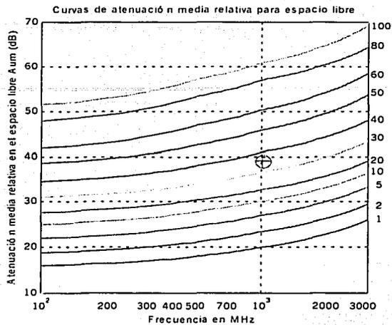
Figura 37. Gráfica del factor  $A_m$  elaborada en la simulación
