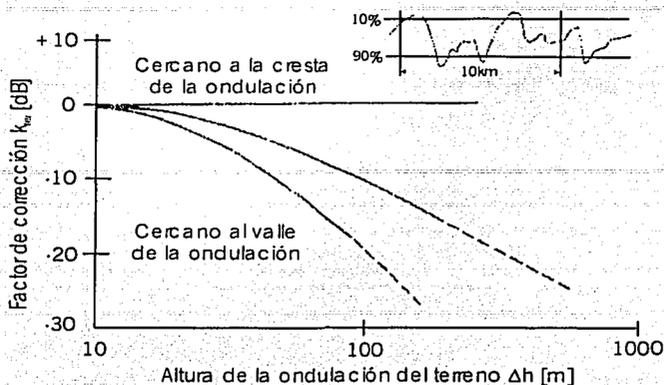
Figura 28. Gráfica del factor de corrección  $k_{err}$
