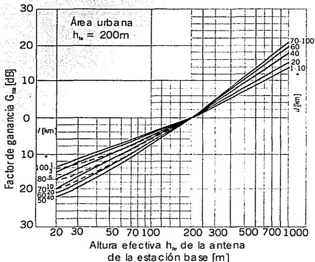
Figura 24. Gráfica del factor de ganancia de altura  $G_{htc}$
