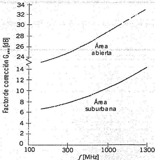
Figura 26. Gráfica del factor de corrección  $G_{400}$ .
