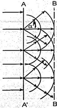
Figura 3. Explicación del Principio de Huygens. Frente de onda plano
