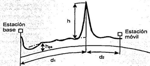
Figura 19. Parámetro de la trayectoria y el obstáculo aislado ( $h$ )
