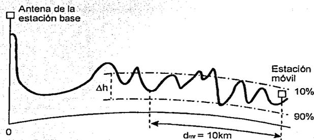
Figura 17. Ondulación del terreno ( $\Delta h$ )
