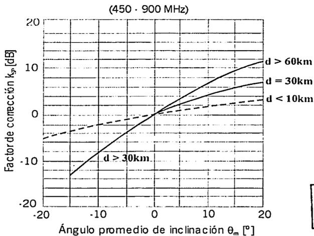
Figura 27. Gráfica del factor de corrección  $k_{SP}$
