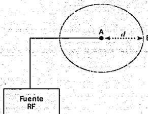
Figura 2. Diagrama de suposiciones para el Modelo de propagación en el espacio libre
