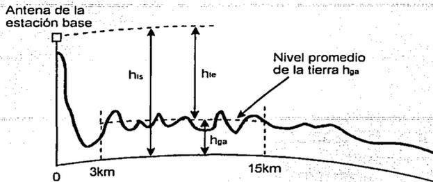
Figura 16. Altura efectiva de la antena de la estación base ( $h_{ie}$ )
