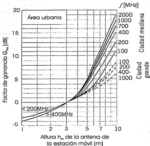
Figura 25. Gráfica del factor de ganancia de altura  $G_{hra}$ .
