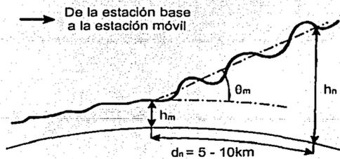
Figura 21. Inclinación media del terreno ( $\theta_m$ )
