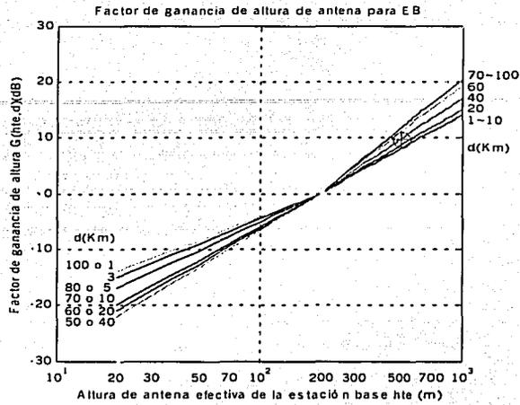
Figura 39. Gráfica del factor  $G_h$ , elaborada en la simulación
