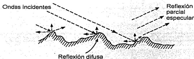
Figura 15. Onda incidente en una superficie irregular
