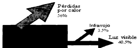
**Figura 60:** Balance energético de una lámpara de vapor de sodio a alta presión
