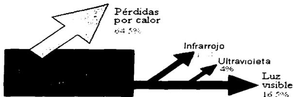
**Figura 50:** Balance energético de una lámpara de mercurio a alta presión
