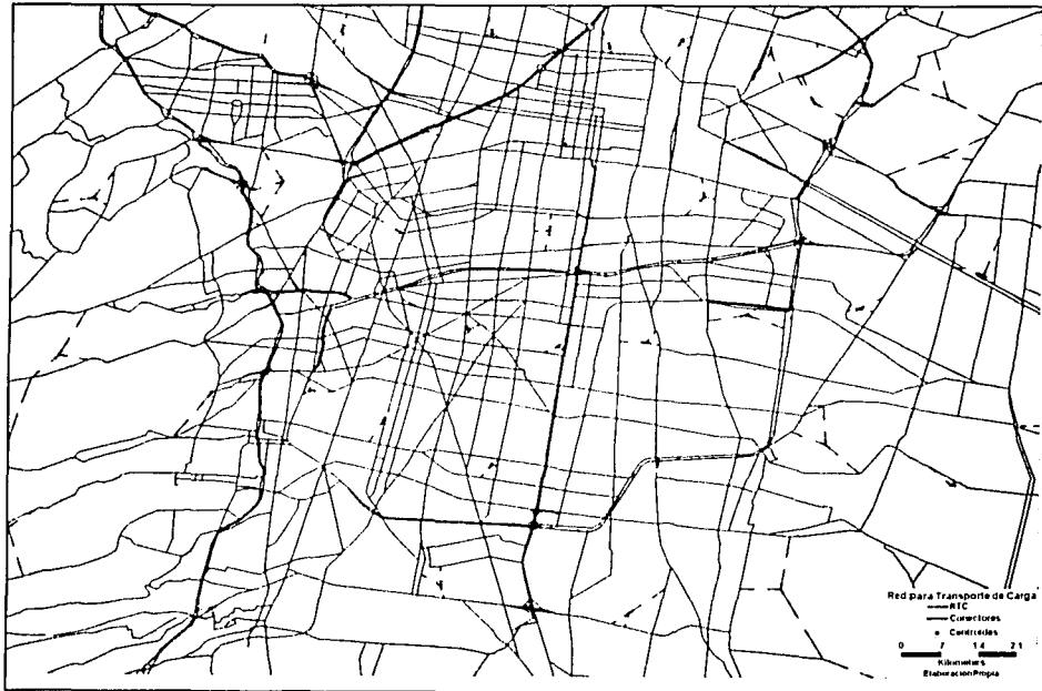
Fig. 6.6-9 Sección de la RTC con conectores de Distrito y centroides de estos Distritos.
