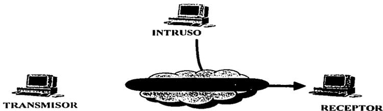
Figura No 2.5 Ataque tipo fabricación.
