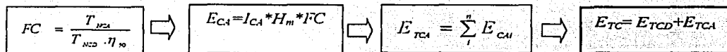
Figura 5.4 Esquema para el cálculo del consumo en corriente alterna y el consumo total de energía.
