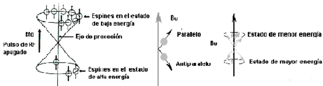
Figura 1.2 Espines paralelos y antiparalelos con sus respectivos estados de energía en ausencia y presencia del campo magnético externo  $B_0$ .
