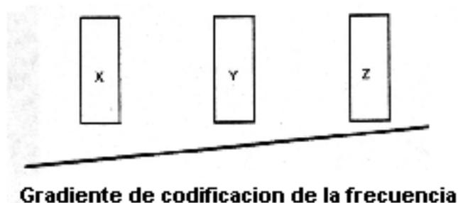
**Figura 1.14 Núcleos precesando a las frecuencias x, y, y z respectivamente**
