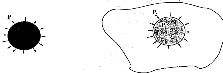
Figura II.2: En la explosión esquematizada en la figura izquierda el gas chocado está contenido en la esfera correspondiente a la onda de choque que evoluciona aumentando su radio. A la derecha se presenta una onda de choque implosiva. En este caso el gas chocado está fuera de la esfera y la onda de choque converge al centro de la nube.
