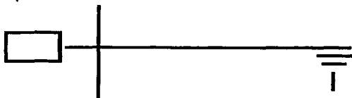
Fig. 3.1 Configuración básica de fallas a tierra en sistemas eléctricos
