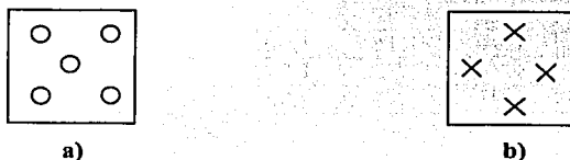
Figura 2.4. Puntos de la película en donde fueron tomadas las mediciones de DO. a) Durante los primeros 38 días post-irradiación. b) a los 64 días post-irradiación.
