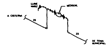
DETALLE DE CUADRO DE MEDIDOR.
