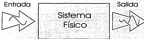
Figura 1.2: Se aplica una señal conocida y se mide la respuesta, la forma de la señal de salida está determinada por las características del sistema.
