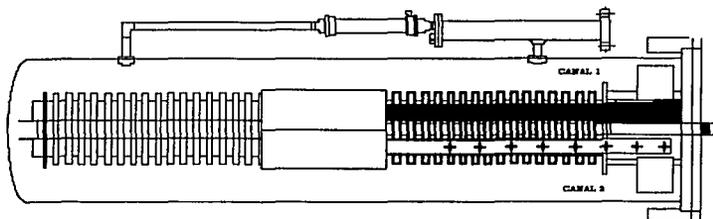
Fig. 1.2 TANQUE DEL ACELERADOR DE PARTÍCULAS
