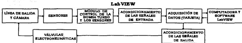
Fig. 2.3 DIAGRAMA DE BLOQUES DE LA AUTOMATIZACIÓN DE LAS VÁLVULAS UTILIZANDO LabVIEW
