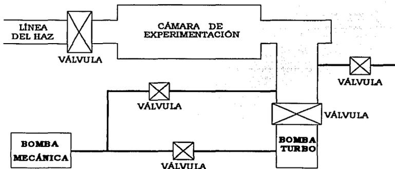
Fig. 1.4 SISTEMA DE VACÍO
