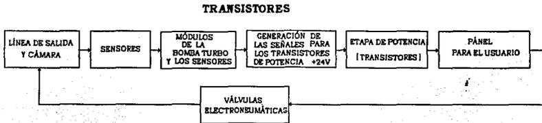
Fig. 2.2 DIAGRAMA DE BLOQUES DE LA AUTOMATIZACIÓN DE LAS VÁLVULAS UTILIZANDO TRANSISTORES
