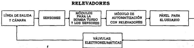
Fig. 2.4 DIAGRAMA DE BLOQUES DE LA AUTOMATIZACIÓN DE LAS VÁLVULAS UTILIZANDO RELEVADORES
