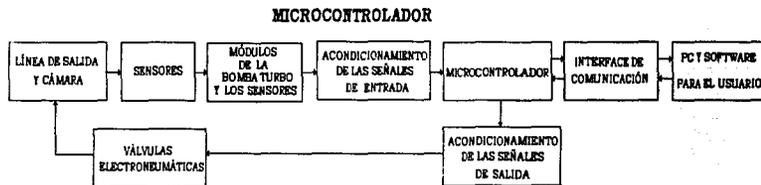
Fig. 2.1 DIAGRAMA DE BLOQUES DE LA AUTOMATIZACIÓN DE LAS VALVULAS POR MEDIO DE UN MICROCONTROLADOR
