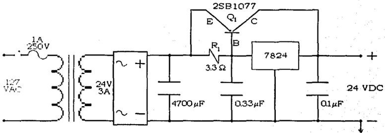
Fig. 3.11 DIAGRAMA ELÉCTRICO DE LA FUENTE DE VOLTAJE REGULADA
