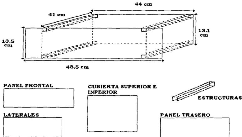
Fig. A2-6 Diagrama del Chasis del Equipo
