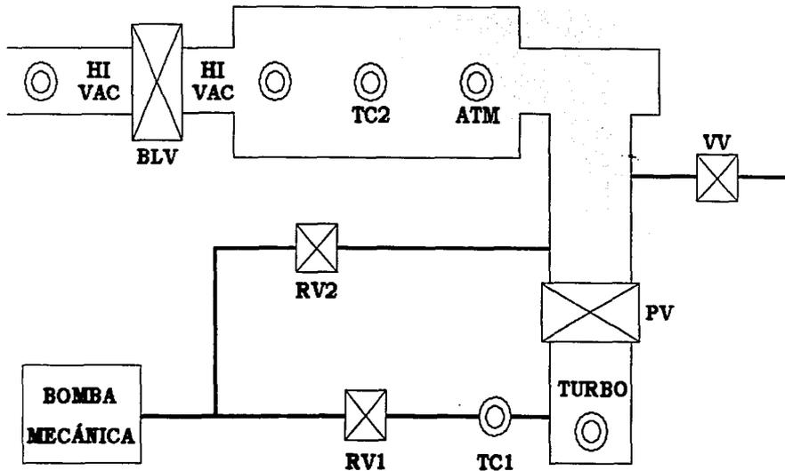
Fig. 3.1 DIAGRAMA DE BLOQUES DEL SISTEMA
