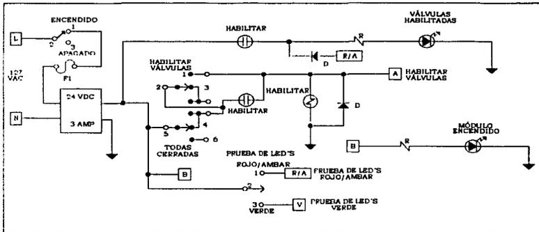
Fig. 3.4 DIAGRAMA ELÉCTRICO PARA HABILITAR LAS VALVULAS
