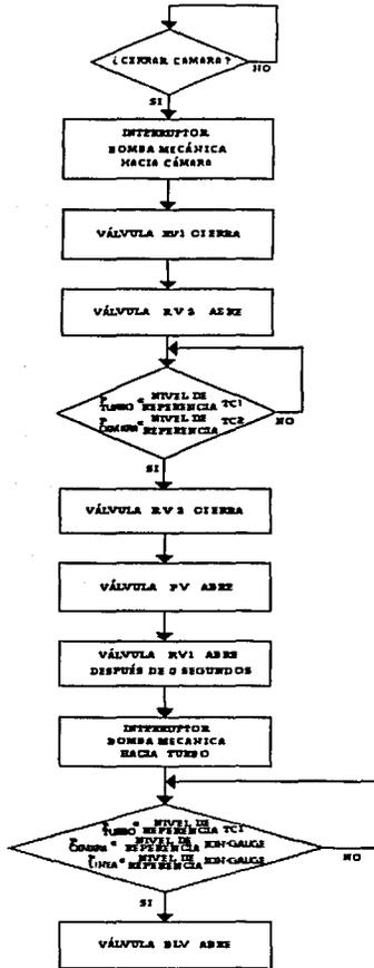
Fig. 3.3 DIAGRAMA DE FLUJO PARA CERRAR LA CÁMARA
