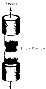
Figura 2.4 Deformación localizada durante el ensayo de tensión de un material dúctil produciendo una región de encuellamiento [11]
