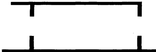
Fig. 4.10 Para incrementar el flujo del aire es recomendable implementar un volado que recoja corrientes de aire que de otra forma escaparían (Fuente Olgay Victor, Arquitectura y Clima p. 110)
