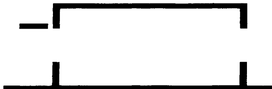
Fig. 4.11 Si se sitúa un volado directamente sobre la ventana se tendrá un efecto desfavorable ya que el viento se dirigirá hacia arriba. Si a este volado o alero se le agrega una abertura para equilibrar las presiones externas, se tendrá un flujo de aire agradable (Fuente Olgay Victor, Arquitectura y Clima p. 111)
