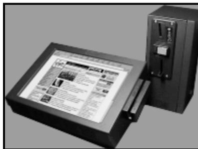
Modelo “Morpheus”. Diseño inglés. Consta de un monitor de 12.1” con pantalla sensible al tacto que sustituye al teclado con uno “ virtual”, contenido en una caja de acero. Los componentes electrónicos están protegidos en un contenedor plástico de inyección. Se puede escoger entre 20 diferentes colores. Puede ser montado en la pared con broches metálicos. Es silencioso y tiene la opción de trabajar con lector de tarjetas de crédito ó pago con monedas.
