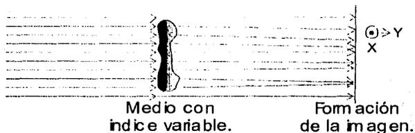
**FIGURA 3.1** La imagen de fotografía por sombras del plasma es consecuencia de la desviación del haz láser expandido.
