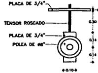
Polea 2 tensor para cambio de dirección
