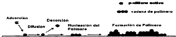
FIGURA 1.11 Esquema de polimerización del p-xileno.
