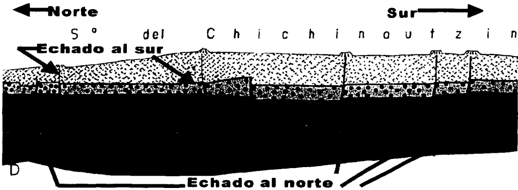
Figura V.2. Detalle del perfil NS de la SC presentado en la figura II.4. En esta figura se hacen notar la existencia de fallas con echados hacia el norte y hacia el sur.
