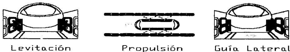
Figura 4.9 - Conceptos Básicos del Funcionamiento "Maglev" 43
