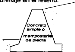
MURO DE GRAVEDAD
