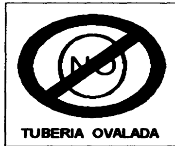
Fig. # 13 Tubería no apta para su unión.
