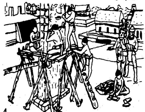
**Figura 2.** Trabajo colectivo en el proceso de levantamiento con armazón "A", apoyos y diferentes palancas.
