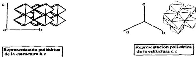
Fig. A1.9 Representación poliédrica de las estructuras hexagonal compacta y cúbica compacta
