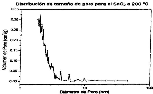
Fig. 4.8.4 Estructura de poro: Calcinado: 200 °C
