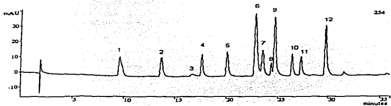
Figura 8. Cromatograma obtenido por inyección directa de 20 \mu L de la mezcla de plaguicidas a 20 ppm y detección a \lambda = 254 nm. Identificación de los picos: (1) deisopropilatrazina, (2) desetilatrazina, (3) 2- hidroxiatrazina, (4) cianazina, (5) simazina, (6) hexaxinona, (7) atrazina, (8) desmedifam, (9) simetrina, (10) propazina, (11) terbutilazina, (12) prometrina. Condiciones descritas en la metodología.
