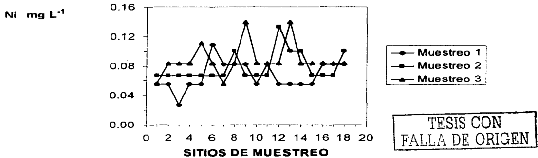
Figura 16. Comportamiento de níquel soluble en tres muestreos de agua de la presa Valsequillo, Edo. de Puebla.
