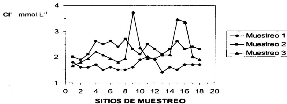
Figura 11. Comportamiento de cloruros solubles en tres muestreos de agua de la presa Valsequillo, Edo. de Puebla.
