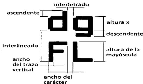
Figura 3. Estructura de las letras en un monitor de cristal líquido.
