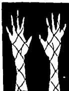
Fig. 13 Jaula de Faraday. Una persona encerrada en una malla metálica no corre peligro porque toda la carga inducida se acumula en la superficie exterior de la jaula.
