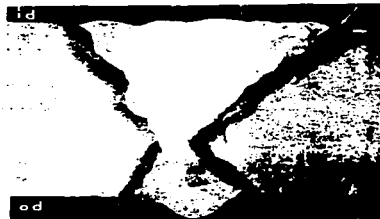
Figura 2.20. Agrietamiento inducido por hidrógeno en la zona afectada por el calor en una soldadura de acero al carbono [36].
