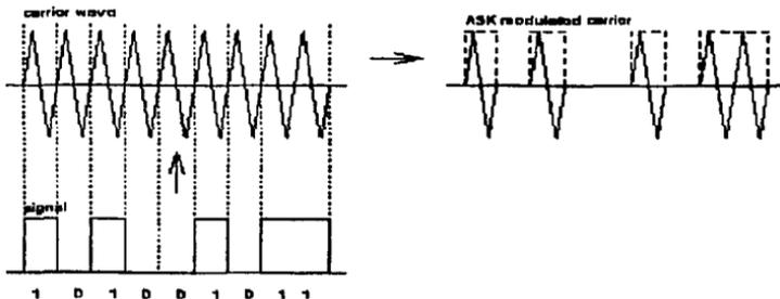
Figura 3.15. ASK (Amplitud Shift – Keying – Codificación por cambio en la Amplitud).
