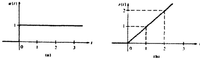
Fig. 3.1. Funciones (a) escalón unitario y (b) rampa unitaria.
