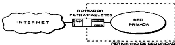
Figura 5.13 Router de Filtrado de Paquetes
