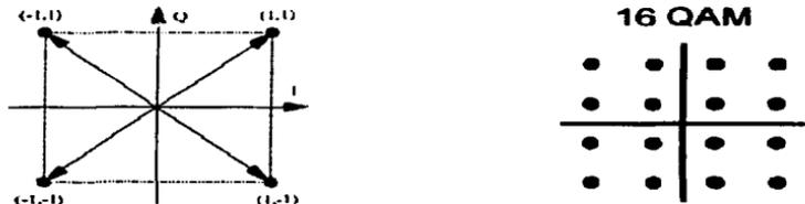
Figura 3.18. Modulación QAM a 4 bits/ bauds.
