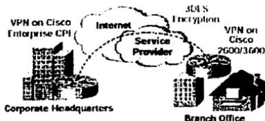
Figura 6.5 Conectividad Punto a Punto con el uso de routers
