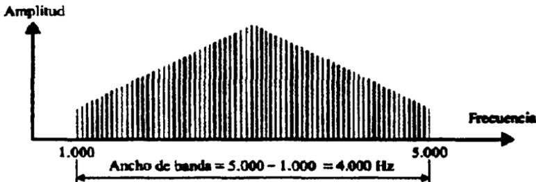
figura 3.12 Espectro y ancho de banda
