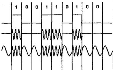
Figura 5.3 Ejemplo de la modulación en frecuencia
