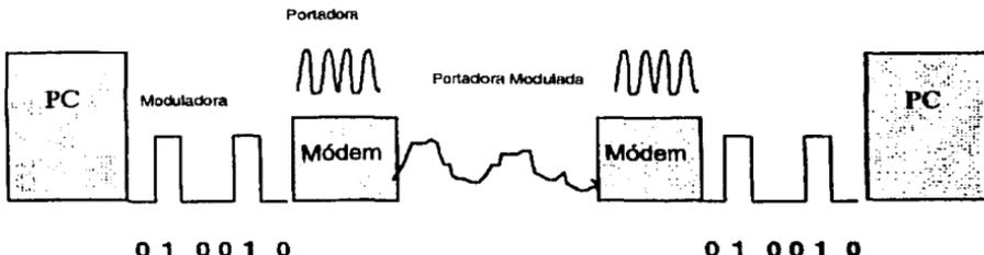
Figura 3.13. Esquema general de la modulación de una señal digital.
