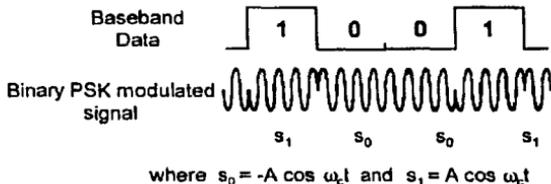
Figura 3.17. PSK (Phase Shift - Keying - Codificación por Cambio de Fase).
