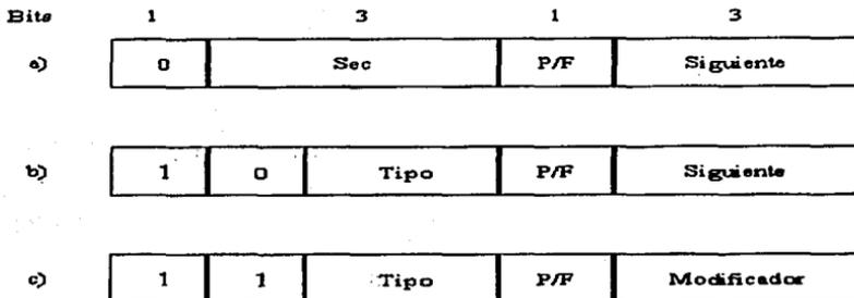
Figura 4.13 Campo de control a) trama de información, b) trama supervisora, c) trama sin enumerar.
