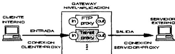
Figura 5.14 Telnet proxy.
