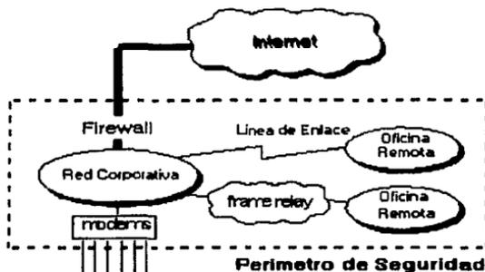
Figura 5.12 Perímetro De Defensa creado por el firewall
