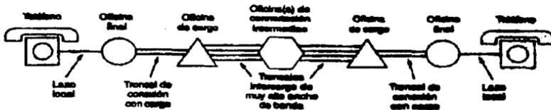
Figura 3.20 Ruta típica de un circuito para una llamada de media distancia
