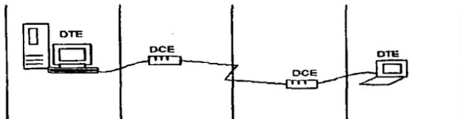
Figura 5.4 Conexión entre dos computadoras por medio del uso de módems
