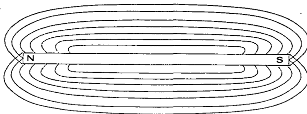
Figura 35. Polos magnéticos en una barra de material ferromagnético. Una barra de material ferromagnético, tiene normalmente dos polos, uno norte y uno sur. La barra está magnetizada permanentemente.
