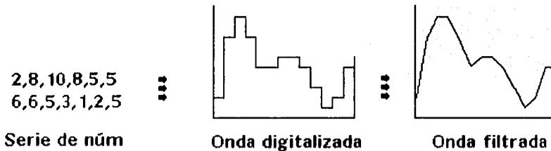
Figura 2.2. Proceso de Conversión Digital-Analógico.
