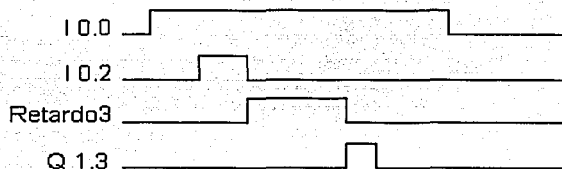
Figura 4-5 Diagramas de los bits de control para una botella caída
