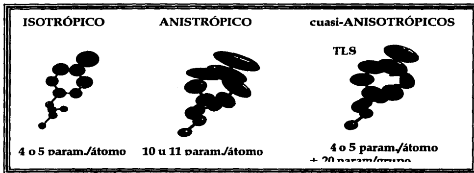
Figura 34. Componentes direccionales de la vibración atómica. Según el tipo de afinamiento que los ajusta los valores B, de izquierda a derecha, se observa un afinamiento isotrópico sin dirección preferencial, el anisotrópico con una dirección marcada por el eje mayor de los elipsoides y por último un cuasi-anisotrópico que describe la dirección pero no la misma magnitud del movimiento que los anisotrópicos.
