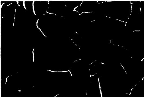
Figura 3.1.6. Detalle de la misma muestra, obtenido a mayor ampliación. Se observa acumulación de material en las fronteras de grano. Se observa daño estructural, dislocaciones y rompimiento de las fronteras de grano.
