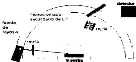
Figura 2.2.4. Arreglo experimental para la difracción de rayos-x de ángulo rasante.
