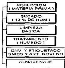
Figura 05 - Diagrama general para beneficio de semillas de Maíz
