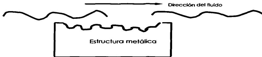
Figura 1.2 Corrosión por picado
