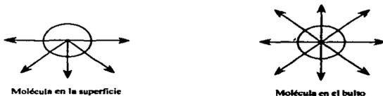
Fig 1-11 Fuerzas actuando sobre moléculas en el bulfo y en la superficie del fluido.
