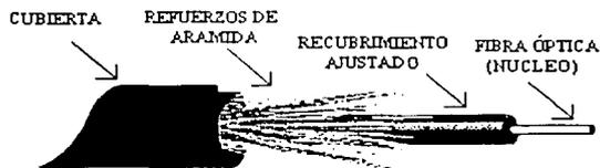
*Figura 2.3 Estructura de la fibra óptica.*
