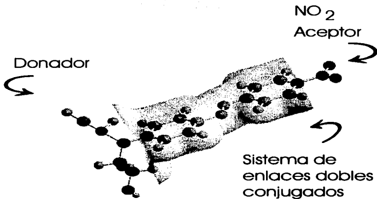
Figura 3: Diagrama de la disposición geométrica de los átomos que conforman la molécula de DR1. La parte sombreada indica la nube electrónica correspondiente a los electrones \pi .
