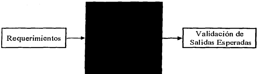
Figura 4.4.5. Prueba de caja negra.
