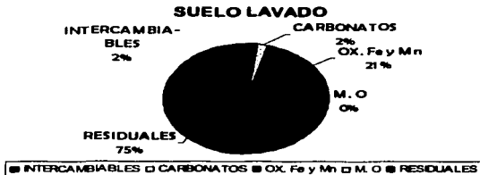
Gráfica 7. Hierro unido a las diferentes fracciones en el sustrato lavado.
