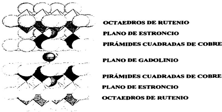
**FIGURA 7.** Estructura tipo perovskita del ruteno-cuprato de estroncio gadolinio,  $RuSr_2GdCu_2O_8$ .
