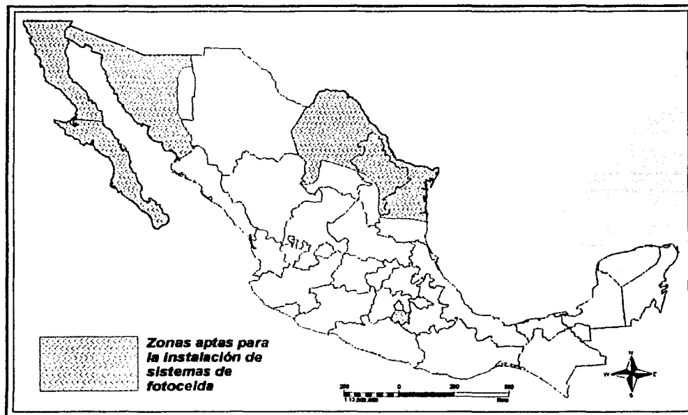
Fig 5.12 Zonas aptas para la instalación de sistemas de fotocelda
