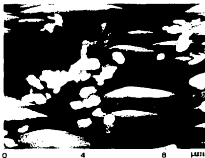
Fig. 33 Imágenes AFM de la superficie del cerámico; a) aspecto general, b) acercamiento a un aglomerado.
