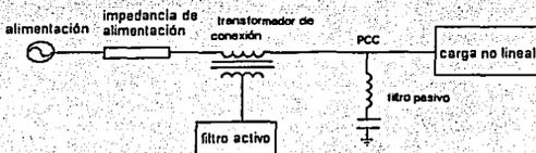
Figura 21 Conexión general de filtro activo en serie y filtro pasivo
