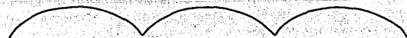
FIGURA 6.4. Conjugada perpendicular a la elipse en sus vértices de mayor curvatura ( e = 0.7 )
