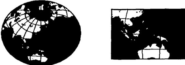
Figura 1.11 Proyección Cónica Conforme de Lambert
