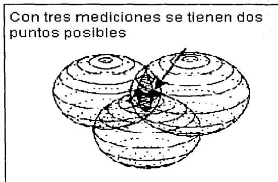
Figura 5. Intersección de tres esferas (Ref. David Wells, Guide to GPS positioning)
