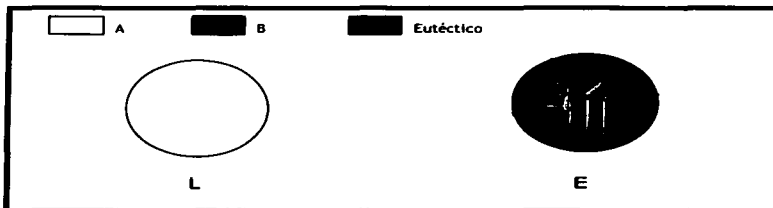
Figura I.6. Formación de la fase eutéctica en la composición c de la Figura I.3.
